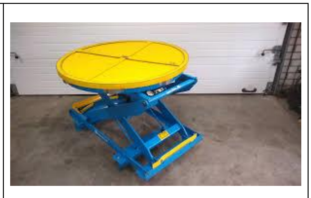
Fig. Mesa tijera con superficie giratoria angular
