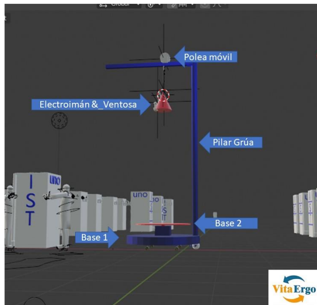
Figura 13. Componentes estructurales de la MET
