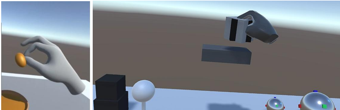
Figura 6. Interacción de ambas manos entre Oculus Quest 2 y Unity 3D mediante físicas.
