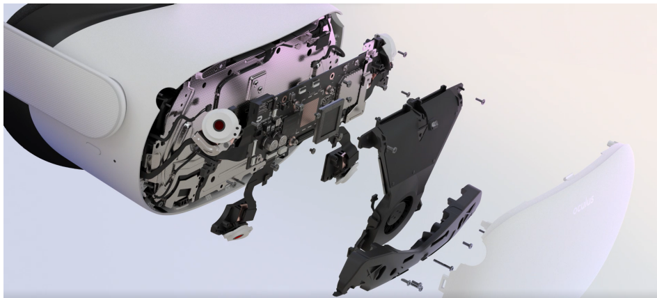
Figura 5. Casco/lente con una mirada interna donde se muestran cámaras, CPU y memoria RAM, entre otros.
